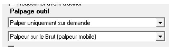
Remontez l'axe Z au maximum, préparez vous à déclencher le contact palpeur avec une tige (pas avec les doigts, c'est dangereux)
