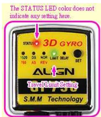
Lorsque ce réglage est fait, appuyez brièvement sur le bouton SET afin de passer au dernier réglage.
