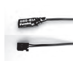
Variomètre et altimètre minia- ture pour émetteur réf. F1733
