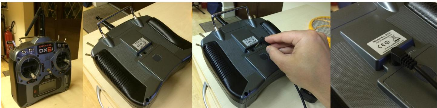
Si votre émetteur ne se met pas automatiquement "sous tension", contrôlez que les prises sont correctement insérées et que vous possédez l'adaptateur approprié (si adaptateur requis), si c'est le cas vous devrez donc mettre votre émetteur sous tension manuellement.
