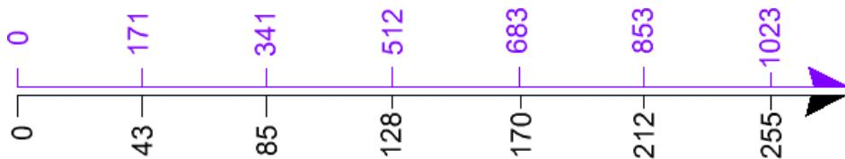
Fig.1 Transposée = (uint32 t) Analog \* 255 / 1023
