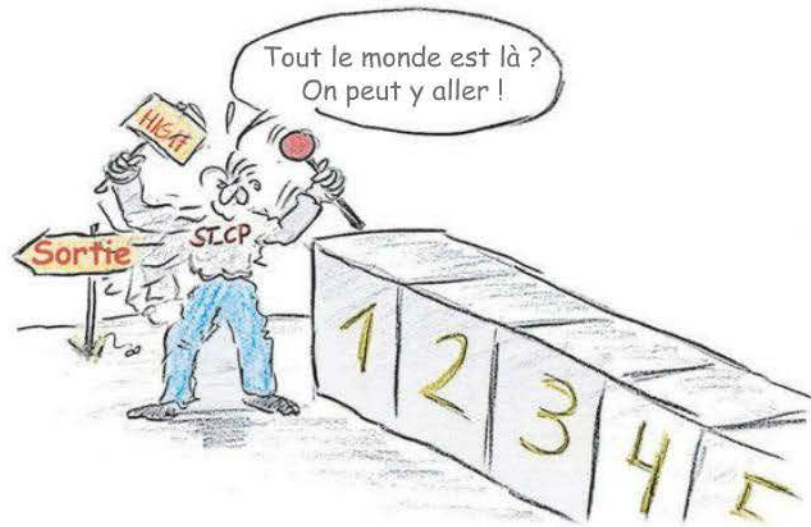
Figure 6-3 ► ST_CP autorisant le départ des données des registres vers les sorties
