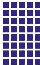
Figure 13-3 ► La matrice de points 5 \times 8 de l'afficheur LCD
