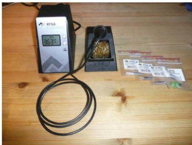
Figure 8-18 ► Station de soudage Ersa avec différentes pannes
