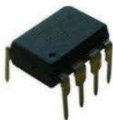
Figure 4-46 ► Le microcontrôleur ATtiny13 dans un boîtier DIP de la société Atmel
