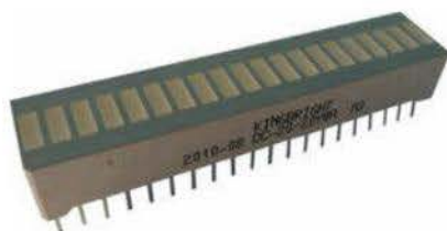
Figure 4-7 ► Bargraphe de type YBG 2000 avec 20 éléments de LED
