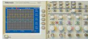
◀ Figure 4-31 Charge et décharge d'un condensateur à l'aide d'un générateur de signaux rectangulaires
