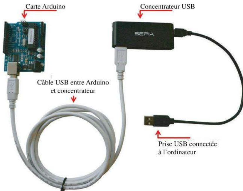
Figure 3 ▶ Utilisez de préférence un concentrateur USB pour raccorder le microcontrôleur Arduino à l'ordinateur.
