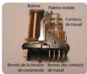
Figure 4-56 ▶ Schéma d'un relais
