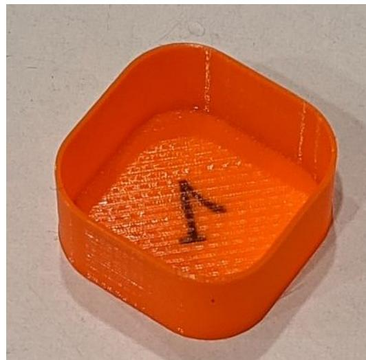
On mesure ensuite l'épaisseur de la paroi pour voir si elle correspond à la largeur de cordon demandée. Comme pour le diamètre du filament, la mesure se fait idéalement avec un [micromètre](#), ou à défaut avec un [pied à coulisse de bonne qualité](#).
