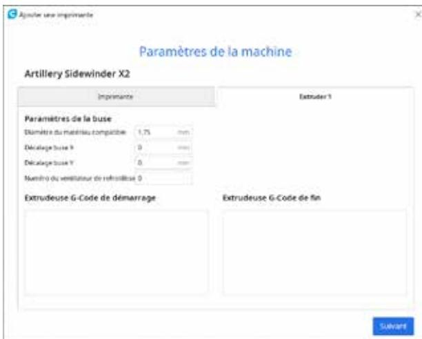
Changer le **Diamètre du matériau compatible** à 1,75
